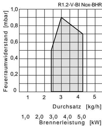
Nach DIN EN 267 geprüftes Arbeitsfeld. Das Arbeitsfeld bezieht sich auf eine Höhe von ca. 200 m ü. NN und einer Raumtemperatur von 20°C.
